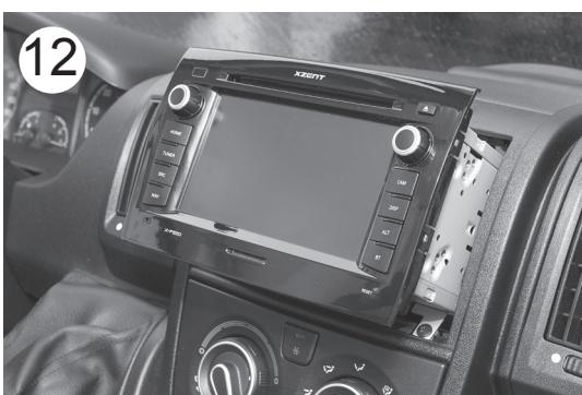
**12** Raccorder tous les câbles au système XZENT (n ° 1): ceux précédemment branchés dans la fente radio et le câble d'antenne d'origine. Si nécessaire, utilisez l'adaptateur d'antenne ISO DIN (n ° 6) inclus dans le kit. Faites ensuite glisser le système XZENT avec précaution dans la fente de la radio jusqu'à ce que vous entendiez l'enclenchement.
