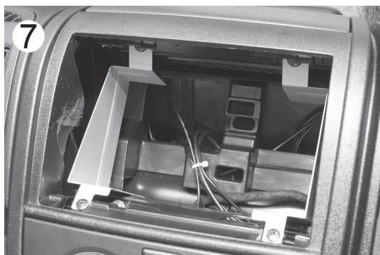
**7** Vissez le cadre de montage en haut et en bas avec les quatre vis Phillips (n ° 3) fournies avec le kit de système XZENT.
