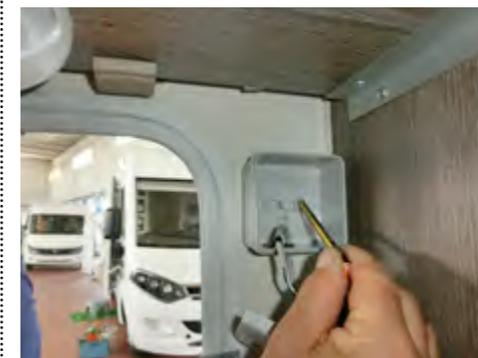
» Ouvrir la boîte avec le commutateur et marquer les trous de fixation (positionnement en proximité de la porte de garage)
