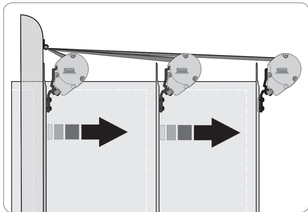
**DE** Zur Reinigung des Inneren der Markise, den Gehäusedeckel wie in der Abbildung 1 abklappen, dabei die beiden gekennzeichneten Schrauben lösen.
