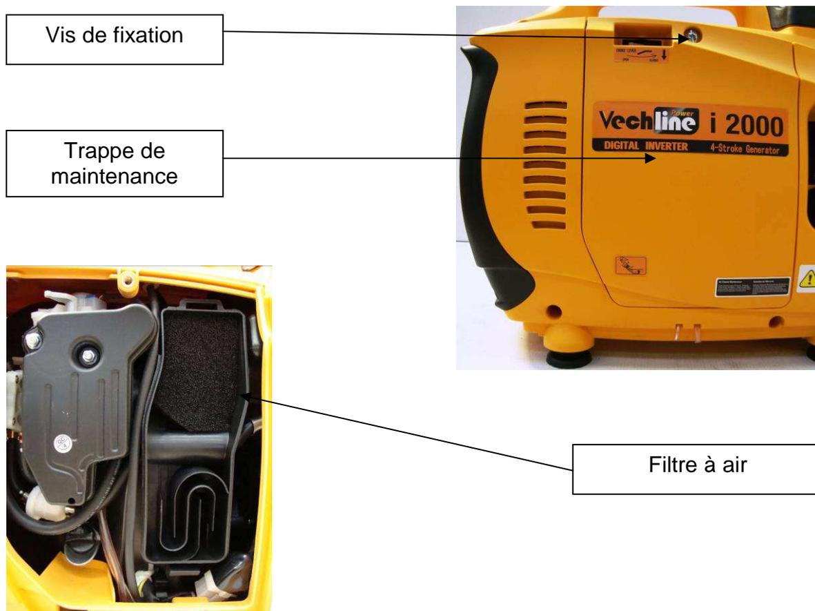
Etape 1 - Desserrez la vis de fixation et déposez la trappe de maintenance.
